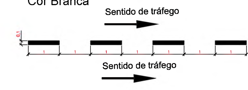
Detalhe "10": Linha de divisão de fluxos de mesmo sentido s/ escala Simplex sectionada (2x4 - Hot Spray) Cor Branca
