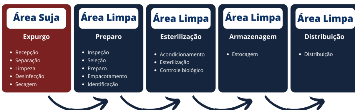
Figura 23. Fluxo unidirecional de materiais na Central de Material e Esterilização. Fonte: Elaboração própria.
